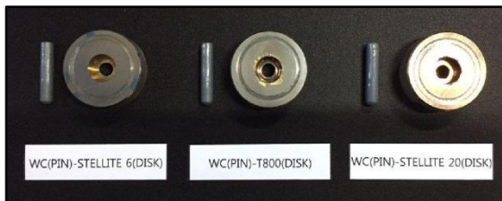
Fig. 2 After Pin on disk test of Specimen Pin의 재질은 동일한 성분의 초경(WC), Disk의 재질은 실제 설비에서 사용하는 Stellite6, T-800, Stellite20으로 하였으며, 660°C 의 온도와 10kgf의 하중, 150rpm, 7200sec로 테스트 조건을 설정하였다. 테스트 방법은 마모시험기 상부에 Pin을 고정,
